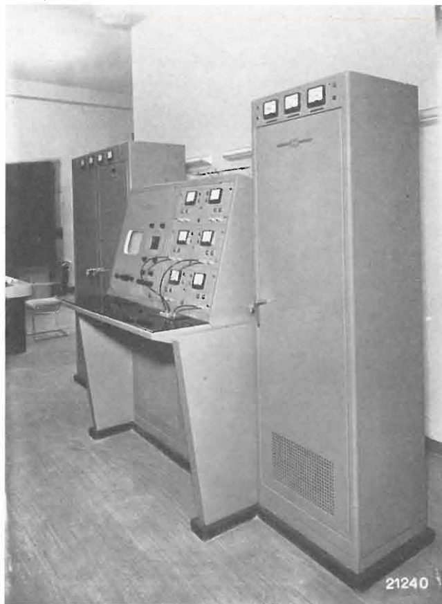
Fig. D — Studio di televisione di Milano: mobile contenente modulatori e rivelatori, e banco di comando.
